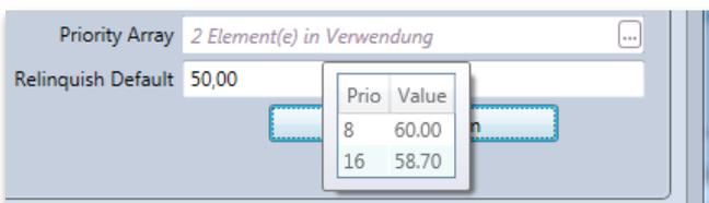
Ein Tooltip wird in der Regel auch angezeigt, wenn der Benutzer mit dem Mauszeiger über das Eingabefeld einer Property fährt. Der Tooltip enthält dann den vollständigen Wert des Property. Bei mehreren Werten werden diese in Listenform im Tooltip abgebildet.
