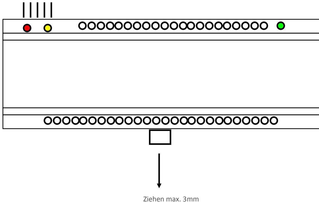
Zum Entfernen des Moduls von der DIN Hutschiene ziehen Sie an der unteren Befestigung und entnehmen das Modul.
