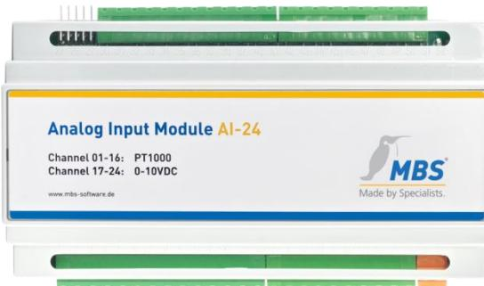
Dieses Modul bietet 16 Kanäle für PT1000 Geber, Auflösung 0,5°C, Temperaturbereich -30 bis +150 °C und 8 Kanäle 0-10V, Auflösung 0,1V.
