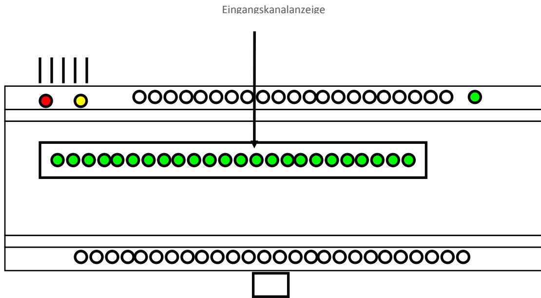
Die Eingangsanzeige zeigt den Zustand der Eingänge mittels LED an.
