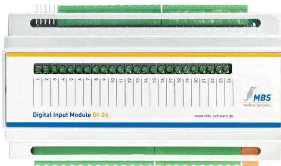
Dieses Modul bietet 24 isolierte Eingangskanäle. Eine LED pro Kanal zeigt den Eingangszustand an.
