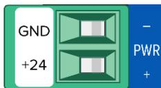
Das Gerät wird mit einem verpolungssicheren Stecker ausgeliefert der bereits in der Buchse [PWR] vormontiert ist. Zum Anschluss der Versorgungsleitungen empfiehlt es sich, den Stecker abzuziehen. Die Leitungen werden entsprechend der Kennzeichnung [+24 / GND] aufgelegt und verschraubt.
